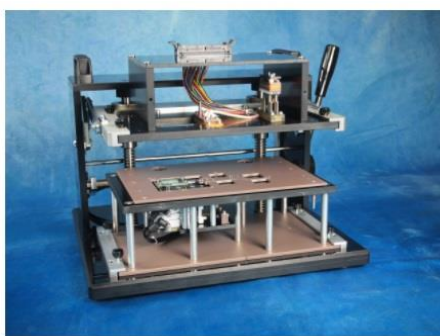
ハンドプレスを用いたフレキシブル基板検査治具。
